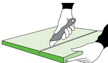
Pour les dalles rigides, inciser à l'aide du cutter la dalle en surface et la casser d'un coup sec en la maintenant à deux mains.
